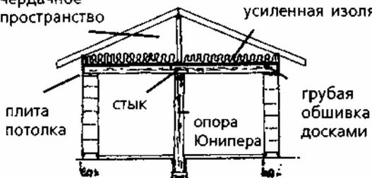
отнесенный в центр здания, несет половину веса крыши. Этот подход снижает нагрузку на линейный фут верхней поверхности двух продольных стен и поэтому снижает степень давления (это плюс, если у вас не самые идеальные с двух сторон пригнанные блоки). Вкопанные вертикальные столбы (кряжи) обеспечивают дополнительное сопротивление боковым (то есть горизонтальным усилиям), возникающим в здании от ветров, или вследствие землетрясений. На рисунке — будущий Дом собраний в Гиле.
