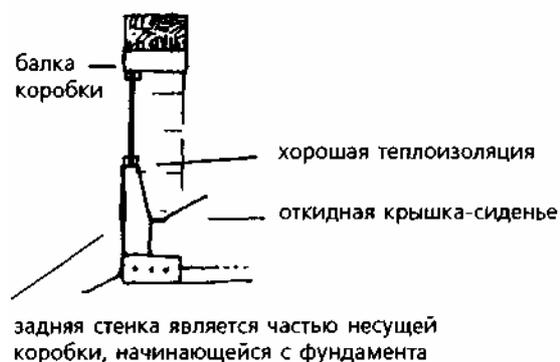
3. Как в п. 2, изготовьте коробки, соответствующие модульным проемам. Затем сделайте вторую, возможно, более легкую, внутреннюю коробку, соответствующую стандартному окну или двери.
