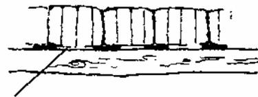
Если это необходимо при вашем климате, используйте гидроизоляционный барьер, чтобы предотвратить проникание влаги, содержащейся в воздухе комнаты, внутрь изоляционного слоя, где она может конденсироваться и замерзать, тем самым существенно снижая коэффициент теплосопротивления изоляции.
